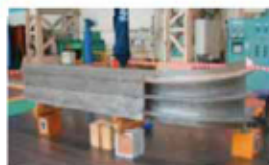
20°上半部試作: インボード直線部と曲線部の接続
